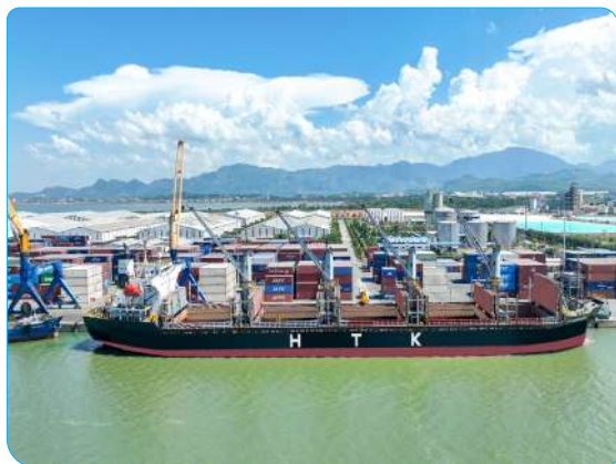
Hình 4.5. Tàu HTK CONFIDENCE dài 169m, rộng 27m, có tải trọng hơn 28.000 tấn cập cảng Chu Lai
